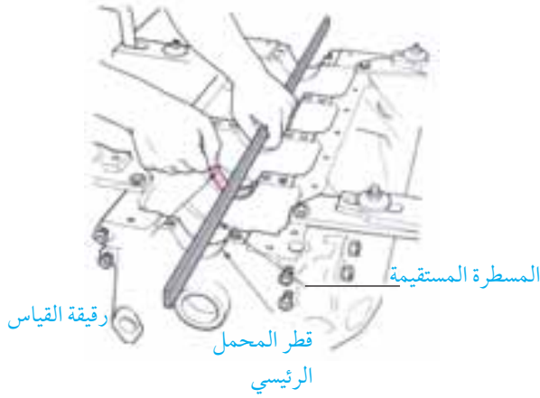
شكل (٨) قياس استقامة الكراسي
